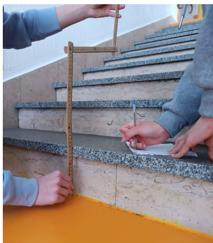
Obrázek 6.2.1: Žáci měřící výšku schodu skládacím metrem
